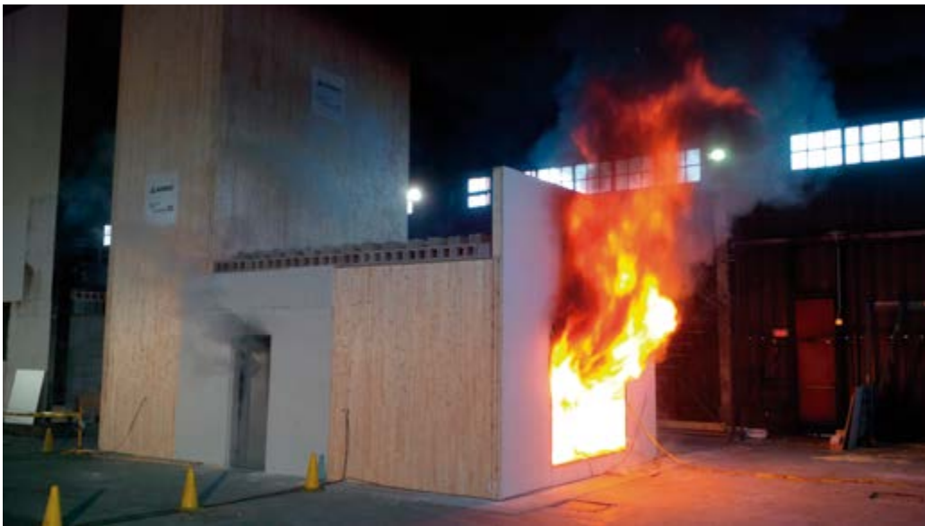
Figura 4: Fotografía del ensayo de comportamiento al fuego de la torre Origine .
