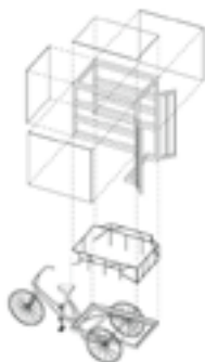
04. REPARTO DE COMIDA Shanghai | Carro | Caja de Metal Una caja fabricada con una delgada placa de metal permite insertar las bandejas de comida y evita que los alimentos estén en contacto con el aire exterior para un transporte higiénico.
