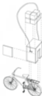
03. TRANSPORTE DE HELADOS Shanghai | Carro | Caja La bicicleta ha sido equipada con cajas de madera para guardar y transportar cajas de helados y aislarlas de la temperatura exterior.
