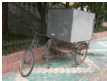
04. REPARTO DE COMIDA Shanghai | Carro | Caja de Metal Una caja fabricada con una delgada placa de metal permite insertar las bandejas de comida y evita que los alimentos estén en contacto con el aire exterior para un transporte higiénico.
