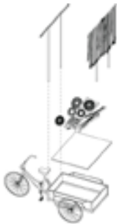
20. VENDEDOR DE CINTURONES Shanghai | Tienda | Tubo de acero Un colgador de acero ha sido soldado a la estructura del triciclo para exhibir diferentes tipos de cinturones que están a la venta. Se ubica a la salida del tren subterráneo, formando en la calle una pequeña feria junto a otros vendedores callejeros.
