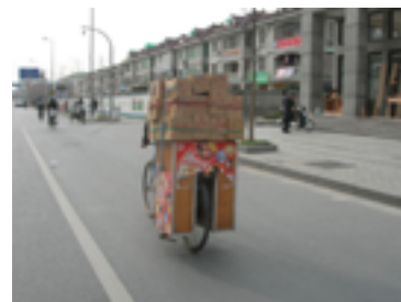
03. TRANSPORTE DE HELADOS Shanghai | Carro | Caja La bicicleta ha sido equipada con cajas de madera para guardar y transportar cajas de helados y aislarlas de la temperatura exterior.
