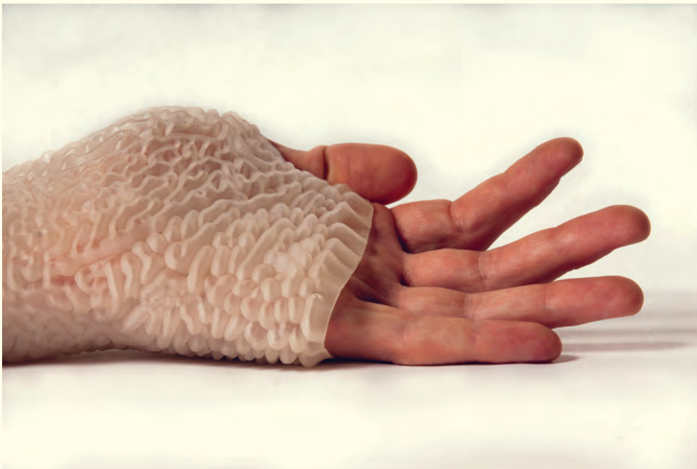
Figura 5: Estrategia de fabricación: "Impresión con propiedades variables guiadas por mapeo de cargas de masas/ superficies complejas" por impresora 3D multi materiales.
