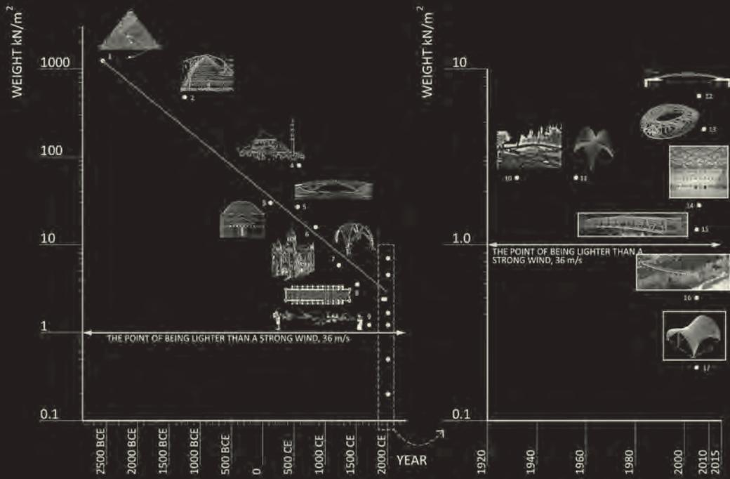
Figura 2: Diagrama de tiempo versus peso para una selección de formas estructurales icónicas. Fuente: Elaboración propia.
