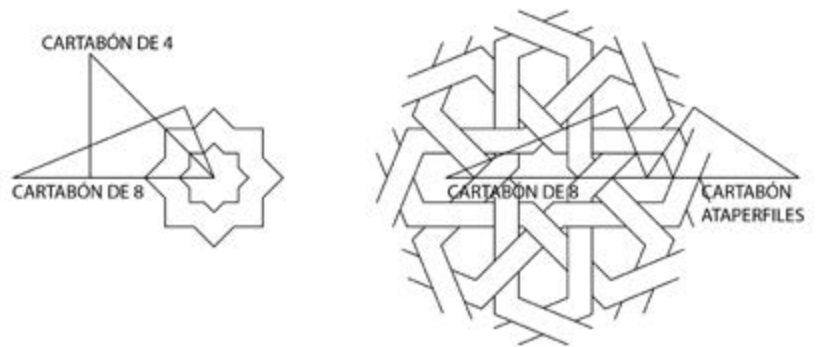
Figura 2: Cortar los encuentros de unas maderas para formar una estrella de ocho puntas requiere saber trazar la bisectriz del ángulo que dichas maderas formen, a lo que ayudan unas escuadras adecuadas, entonces llamadas "cartabones" por tener un ángulo recto (cartabón deriva del latín quartum bonum ). Para la rueda dibujada a la derecha se necesita un cartabón que establezca la bisectriz entre el diámetro, y el lado del polígono regular de tantos lados como puntas tenga la estrella escogida.
