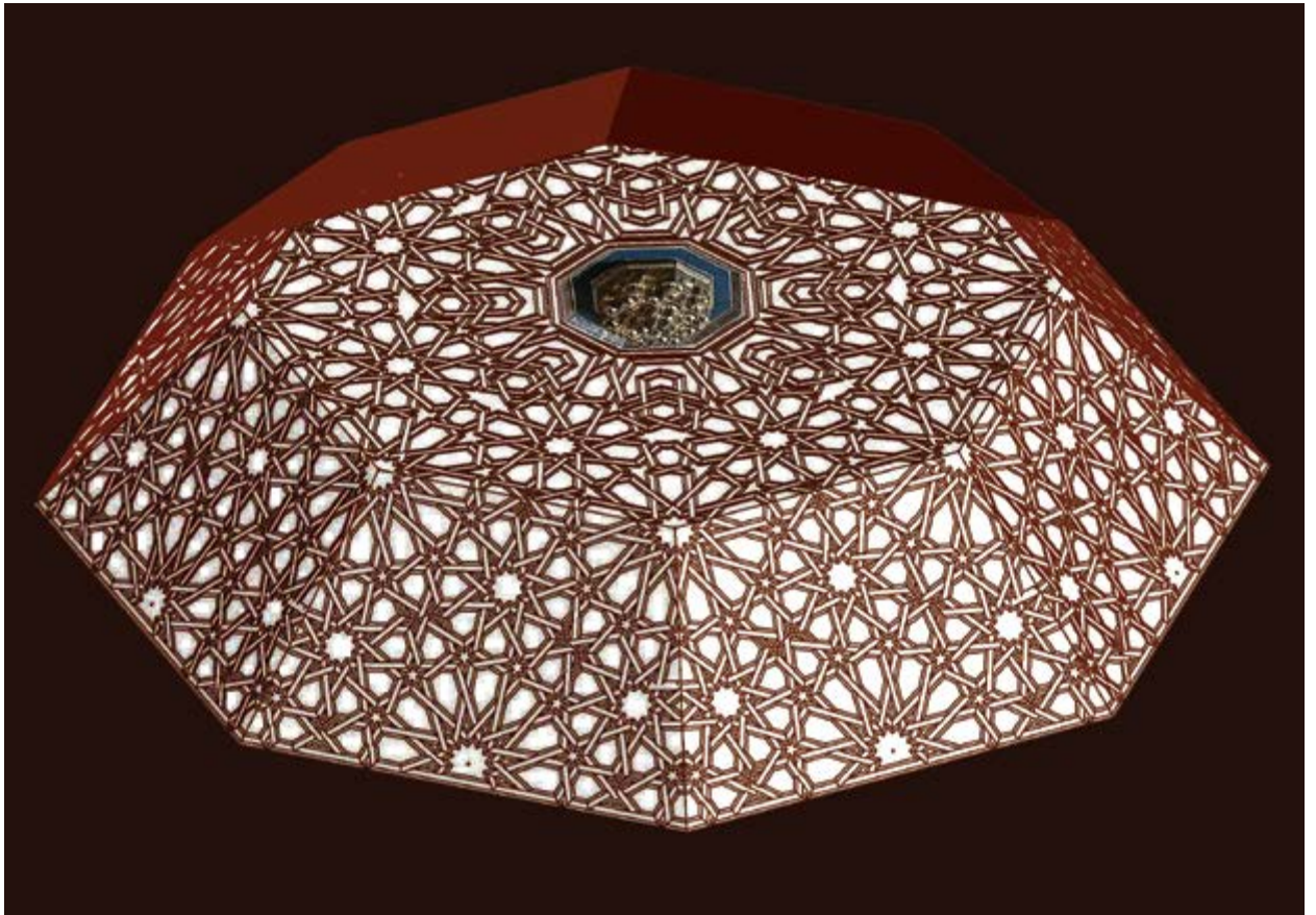
Figura 7: Posible solución de carpintería (elaborada por el autor) en la que las ruedas en los vértices dan continuidad a la traza por todos los paños. Fuente: Elaborado por el autor.
